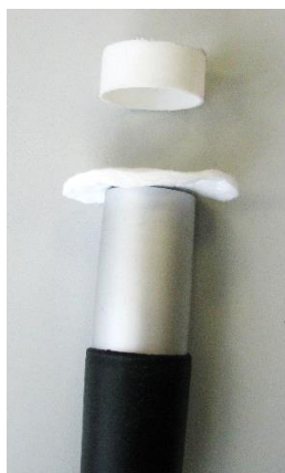
Rysunek 2. Sposób umieszczenia filtra w głowicy.
