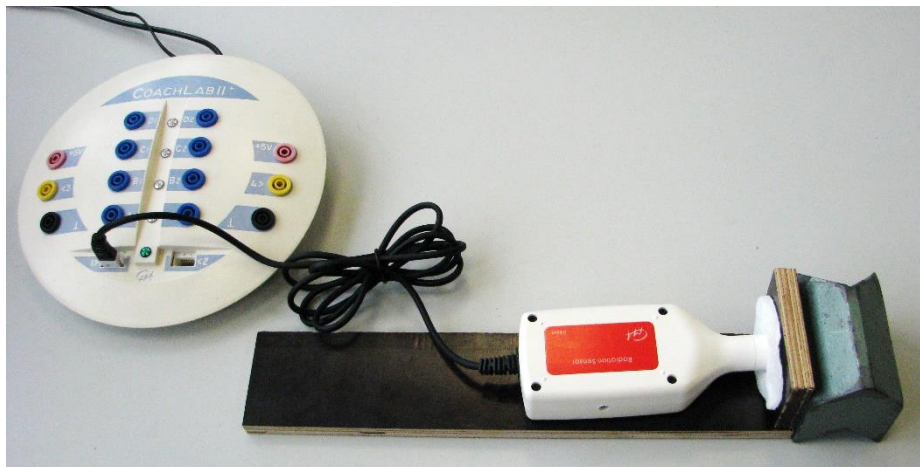
Rysunek 3. Przykładowy sposób ustawienia próbki przed detektorem.
