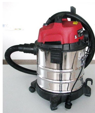
Rysunek 1. Odkurzacz przystosowany do pobierania próbki.
