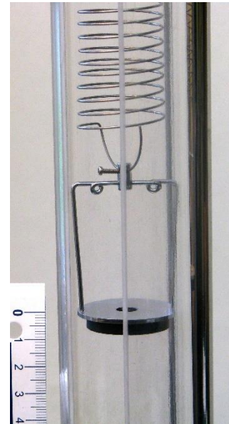
Rysunek 1. Uchwyt z magnesami poruszającymi się wewnątrz rury.
